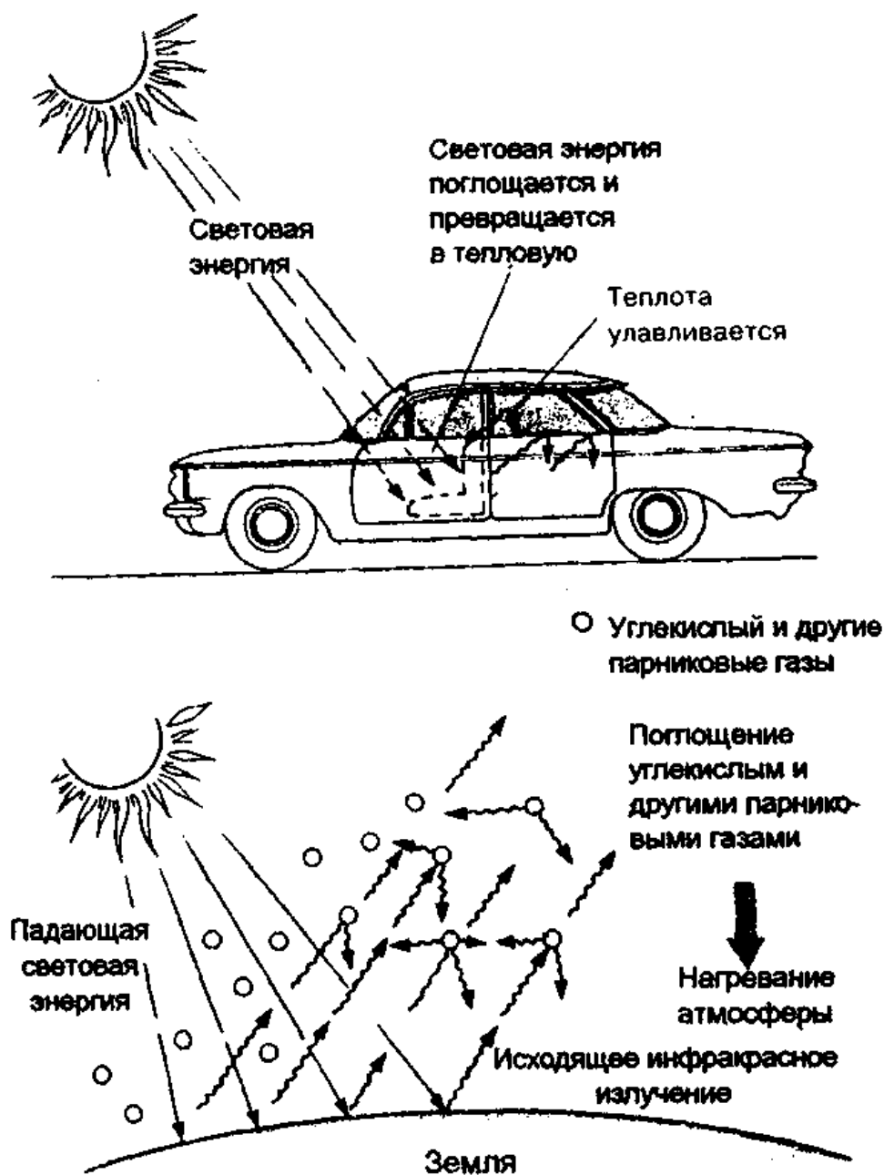
Рис. 8. Парниковый эффект, по Б. Небел. Автомобиль или парник нагреваются на солнце, так как световая энергия, проникающая внутрь через стекло, поглощается и превращается в тепловую, т. е. в инфракрасное излучение, не проходящее через стекло. Когда теплота таким образом улавливается, температура поднимается. Аналогично нагревается атмосфера Земли: свет сквозь нее проникает, а инфракрасное излучение поглощается парниковыми газами. Чем выше концентрация этих газов, тем сильнее нагревается атмосфера
